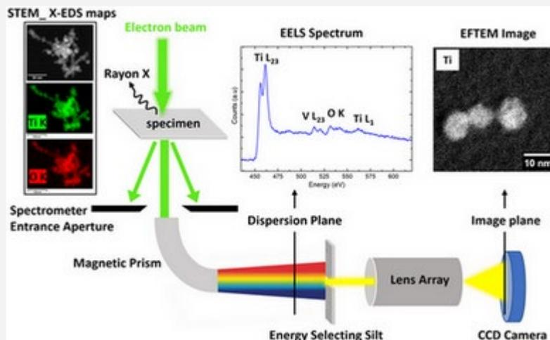
Schéma de principe du filtre en énergie Gatan de notre microscope. Un exemple d'analyses chimiques par *X-EDS*, *EELS* et *EFTEM* sur des particules de  $\text{TiO}_2$  est représenté. (Matériau : Slavica Stankic ; INSP) Plateforme de microscopie électronique en transmission FCMat.
