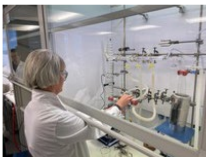
Rampe à vide
